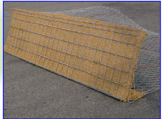
**Foto 1 – System der Fertigteil Bewehrte Erden FAST-TER. Das Bild zeigt die Eigenschaften der frontalen Wandfläche**
